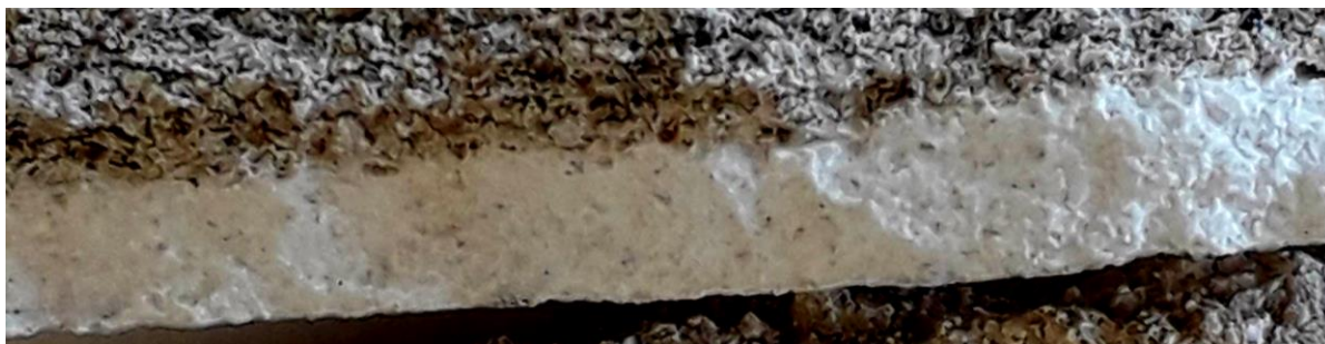
Εικ.9 τελευταία στρώση ασβεστοκονιάματος προς τα έξω
